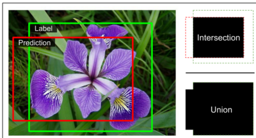
Figura 2.13: A la izquierda se observa un ejemplo de una “bounding box” predicha (rojo) y la real (verde). A la derecha se observa de forma gráfica el cálculo de la IoU. Extraído de [6].
