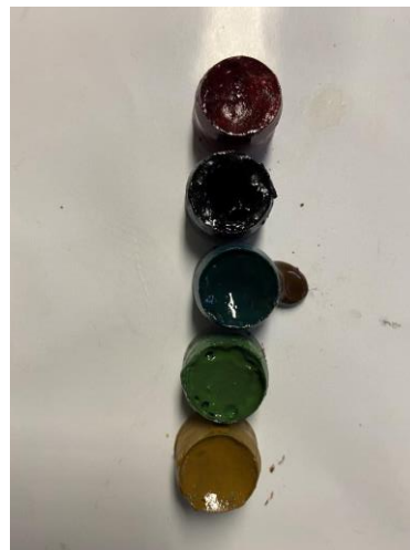
Ilustración 159: Pinturas (Pigmento puro + Laropal A51) utilizadas para la regulación de tonos.
