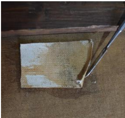
Ilustración 40: Parche engomado, sin flecos y adherido con pegamento de contacto.
