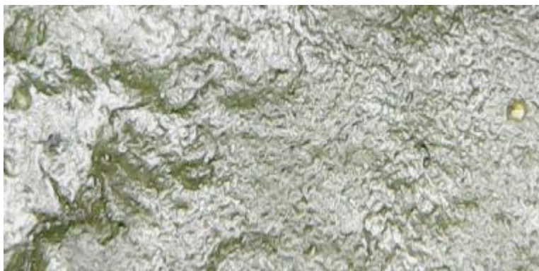
Ilustración 31: Microscopia digital, lado izquierdo se aprecia la rugosidad de el repinte previo de color verde.
