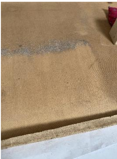
Ilustración 97: Limpieza mecánica en el reverso con goma.
