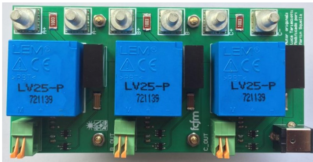
Figura 3.16: PCB soldada con los transductores de tensión y sus respectivos componentes.
