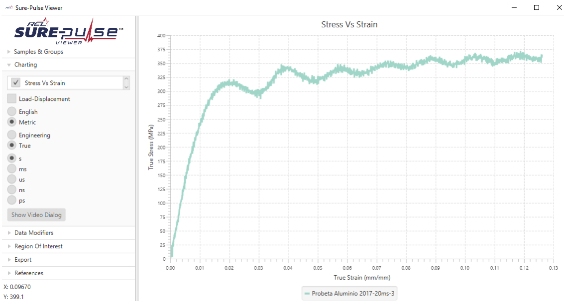
Figura 3.7: Curva esfuerzo deformación extraído a través de los pulsos de deformación.
