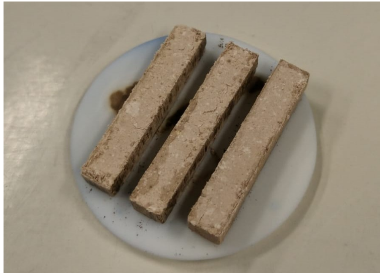
Figura 3.1: Muestras después de el proceso de sinterizado
