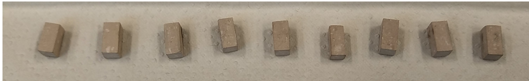
Figura 3.4: Primera producción de muestras cortadas y pulidas de LaAlO_3
