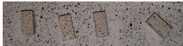
Figura 3.6: Pintado de patrón de moteado mediante salpicadura sobre muestras.
