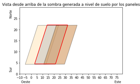
Figura 5.1.3: Sombra conjunta para el modo Sun Tracking para un 28 de Septiembre a las 8 hrs.
