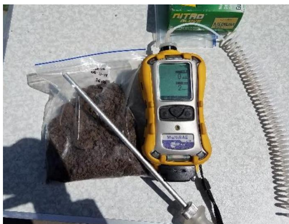
Figura 13: Toma de muestra en terreno con sensor de COV mediante fotoionización (PID).
