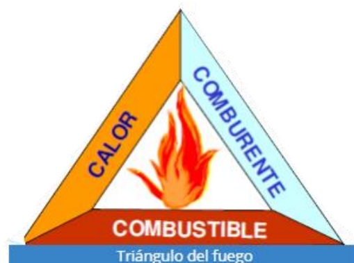
Figura 12: Triángulo del fuego.
