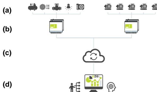
**Figura 4:** Representación funcionamiento de la plataforma IoT. (a) Integración de diferentes sensores. (b) Adquisición de datos y análisis previo en el hardware Ezeio. (c) Nube de almacenamiento de datos Ezeio control. (d) Interfaz del usuario.
