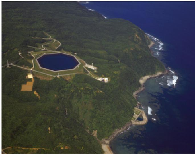
Figura 2.4: Central hidroeléctrica de bombeo de Okinawa
