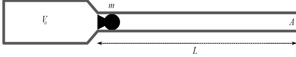
Figura 2.6: Diagrama del tramo de aceleración de largo L , área de sección transversal A , unido a un estanque presurizado de volumen V_0 [2].
