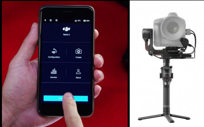
La solución más asequible para nuestro tamaño de producción es la utilización del estabilizador electrónico DJI RS2 en conjunto a su aplicación para teléfonos, que permite programar movimientos repetitivos de sus motores de 3 ejes.
