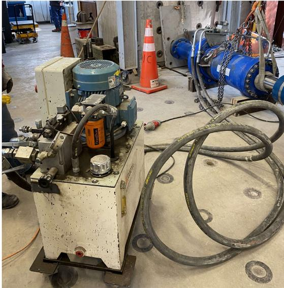
(a) Bomba hidráulica de actuador
