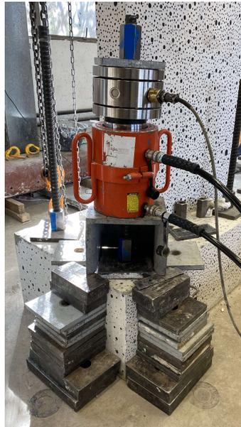
Figura 4.9: Mecanismo postensado de barras
