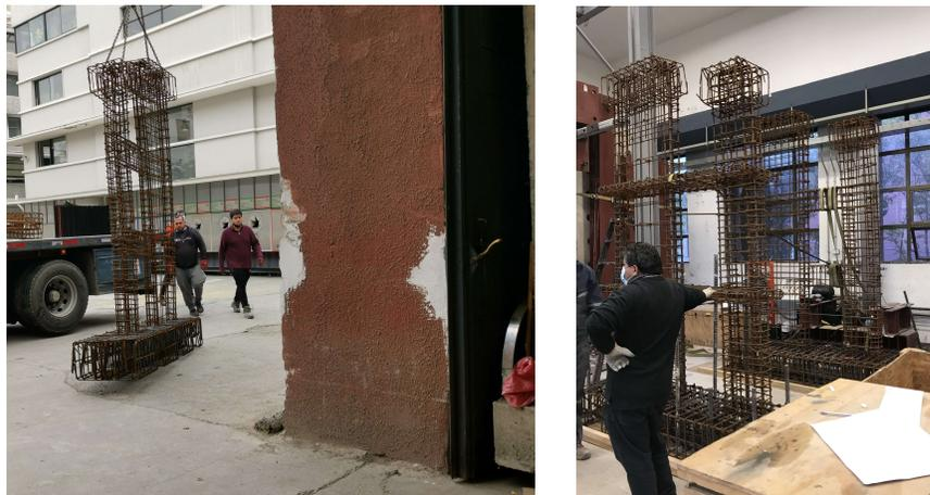
Figura 4.3: Enfierradura de probetas en laboratorio
