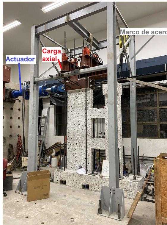
Figura 4.17: Montaje completo ensayo
