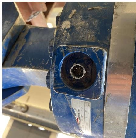
Figura 4.12: Entrada celda de carga actuador
