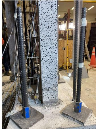
Figura 5.52: Base izquierda muro MR1 2 % drift
