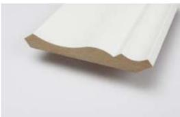
**Molduras MDF:** las molduras se comercializan en distintos perfiles y espesores. Se utilizan principalmente para realizar terminaciones en encuentros pared-piso, pared-techo y en marcos de puertas y ventanas
