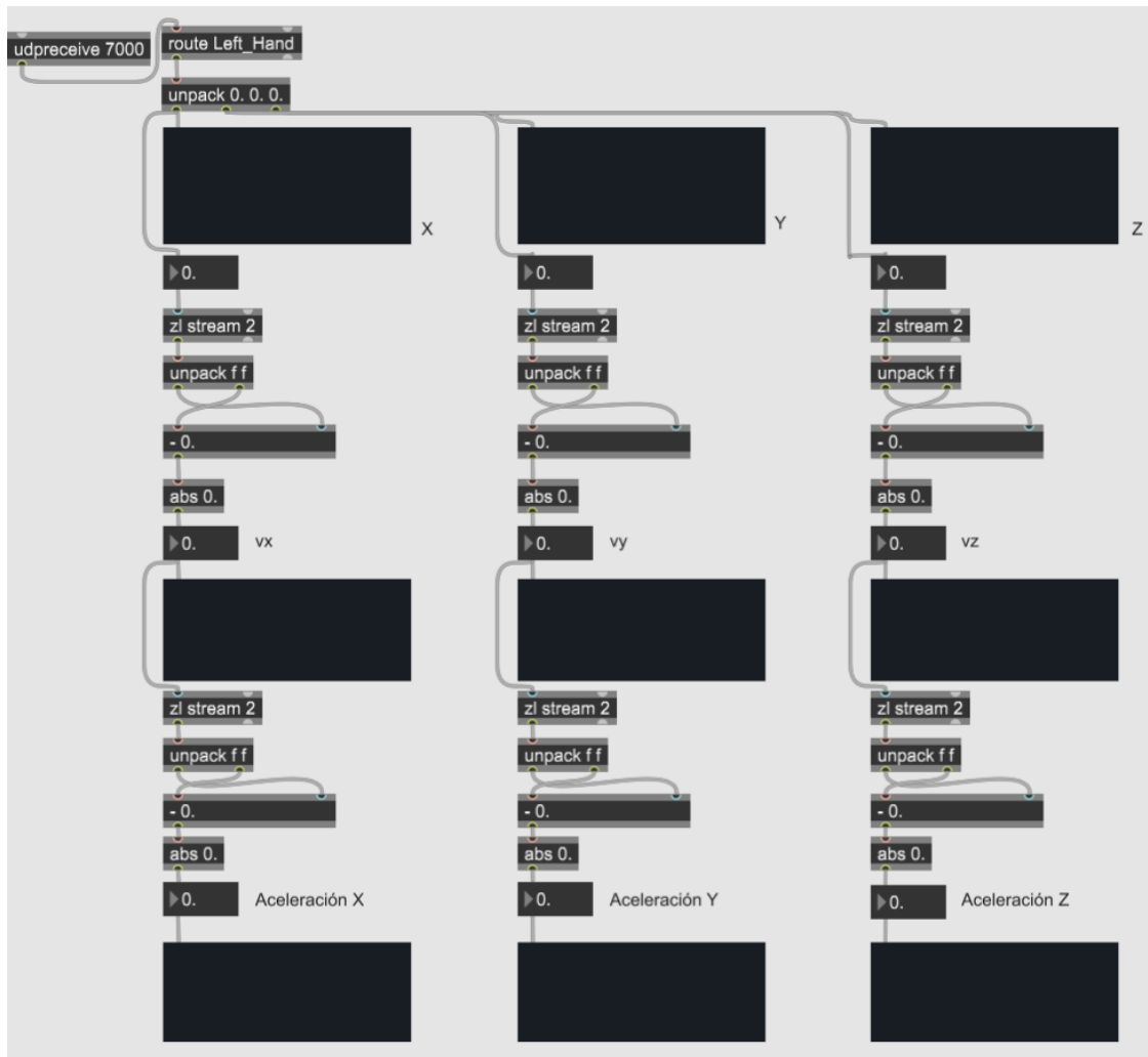
Figura 13: Captura del parche en la sección del cálculo de velocidad y aceleración de los ejes x, y, z de la Mano Izquierda, en tiempo real.
