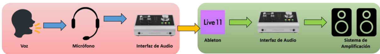
Figura 17: Representación gráfica del flujo de señal en la Sección de Sonido.
