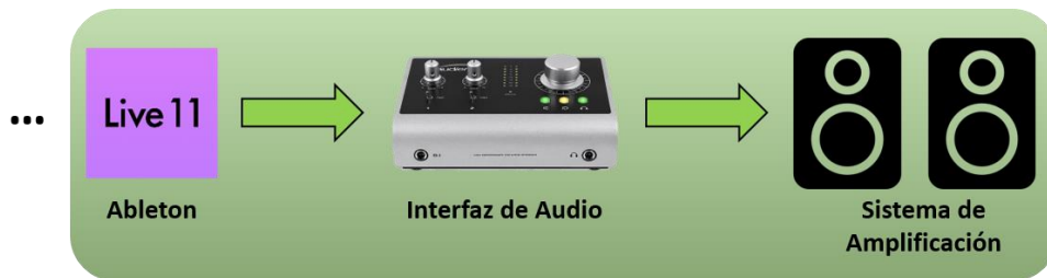
Figura 9: Flujo de señal del prototipo diseñado del sistema, el cual incluye sección de Baile, Sonido, Mapping, Efectos Digitales, Amplificación.
