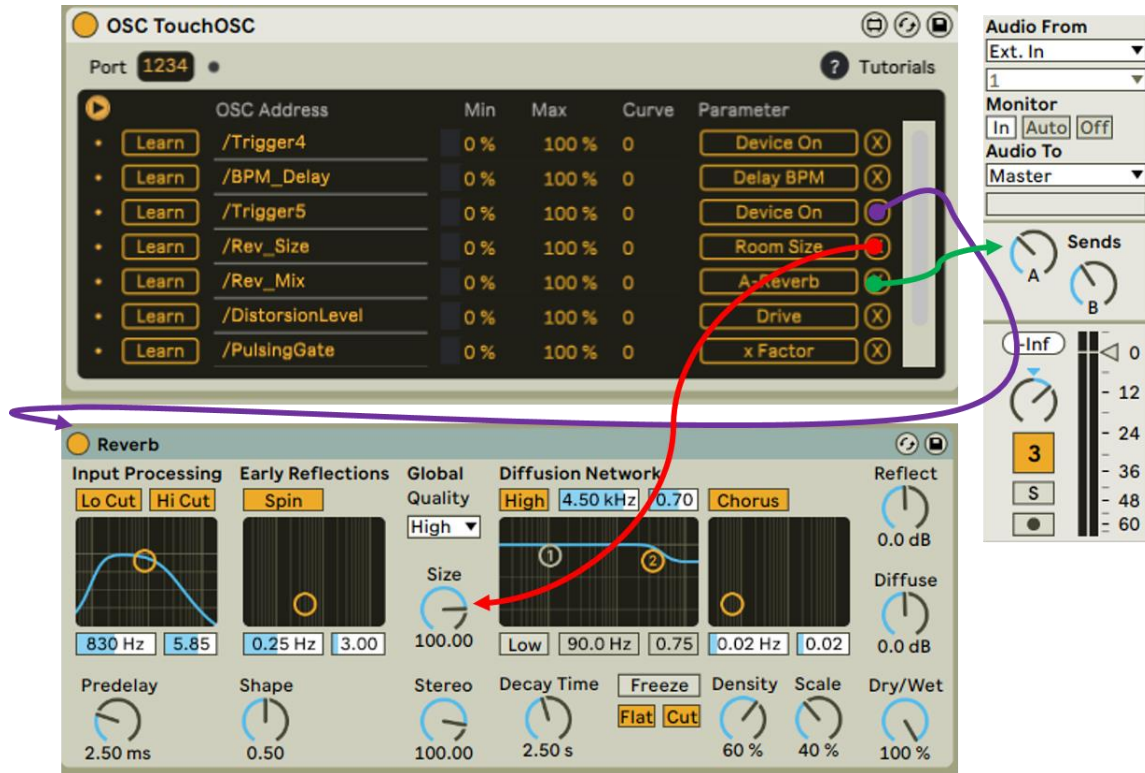
Figura 31: Flujo de Mapping desde Max 8 a Ableton Live, recibe señal Trigger para encendido/apagado, tamaño sala reverberante y presencia efecto en la mezcla.
