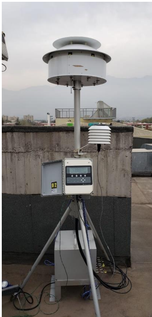
Figura 4. Equipo Super SASS en azotea de edificio milenio.
