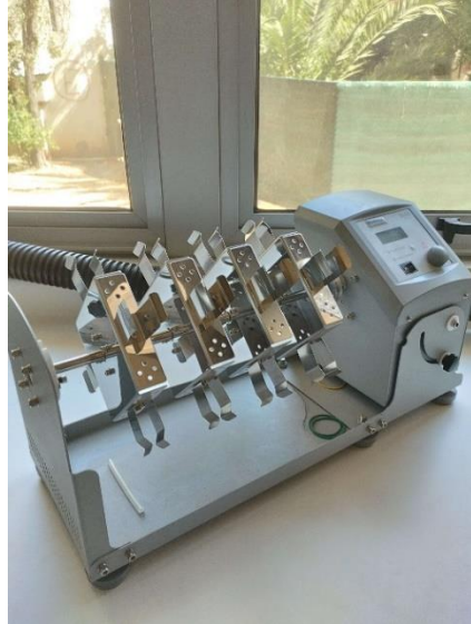
Figura 4. Fotografía del sistema de agitación de muestras (Elaboración propia).
