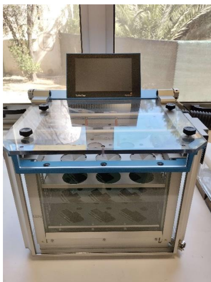
Figura 5. Fotografía del sistema de concentrado de muestras Turbo Vap II
