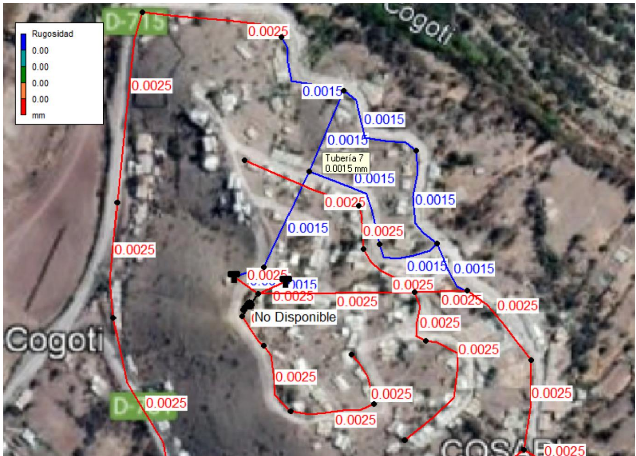
Ilustración 39: Material tuberías APR Cogotí, sector Cogotí.
