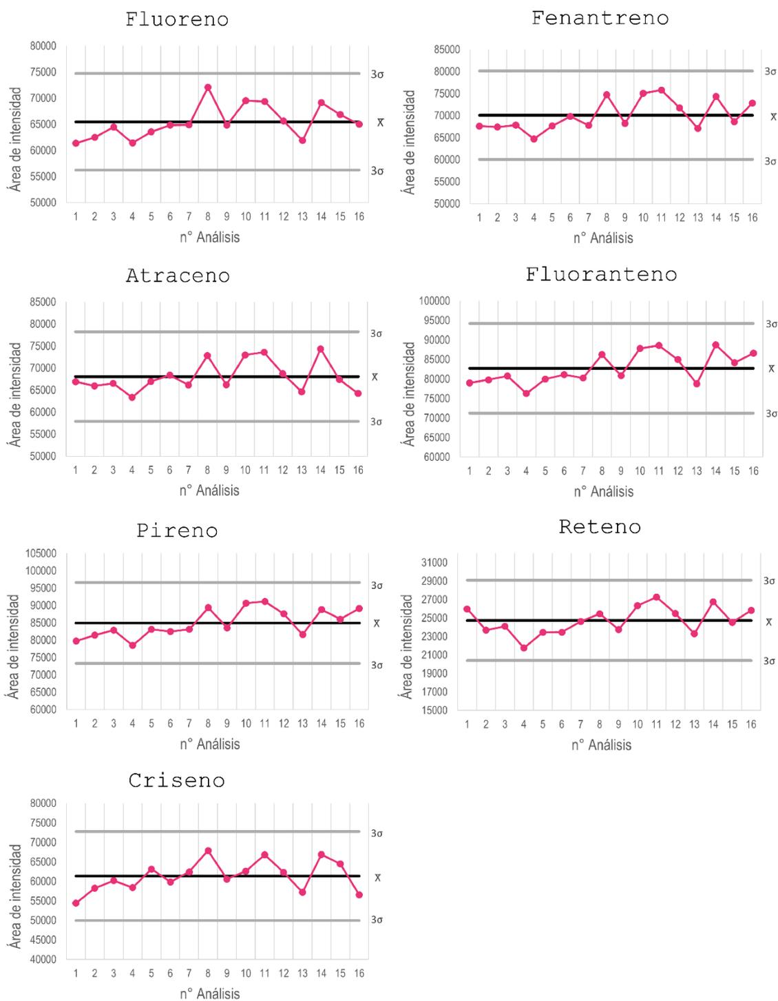
Figura 26. Área de intensidad de pico cromatográfico por analito según n° análisis control
