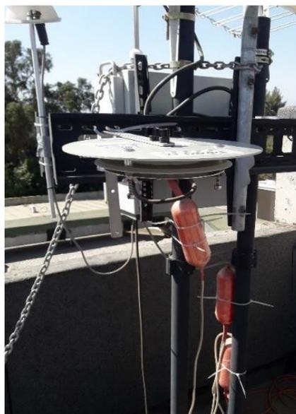
**Figura 8. Captador PAS-DD en el sitio P2**
