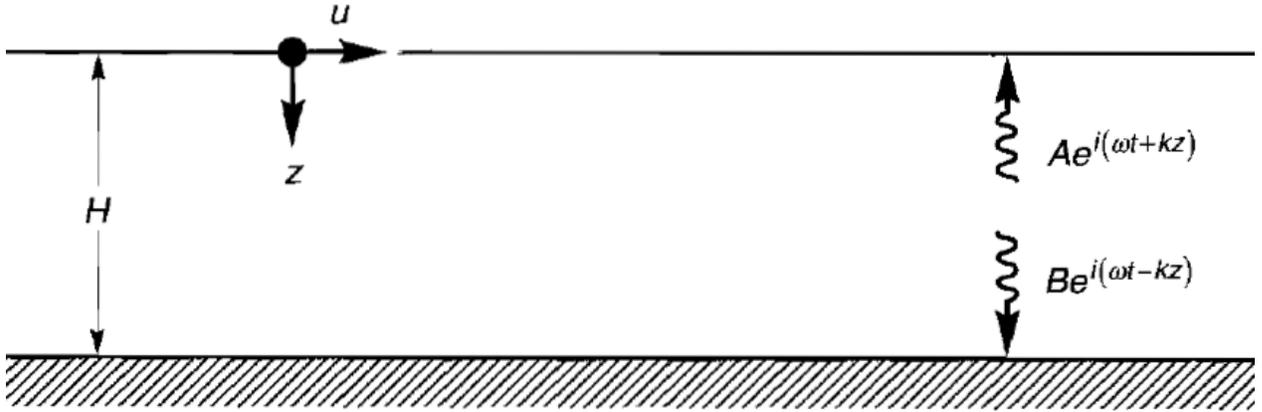
Figura 2.3: Columna de suelo lineal elástico de una sola capa, con espesor H, sobre una roca basal rígida (Kramer, 1996).
