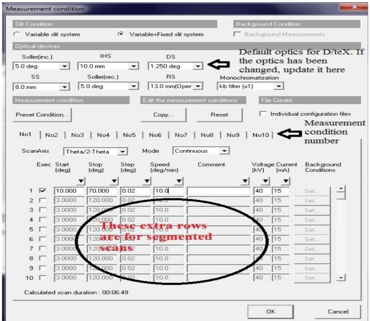
Figura 29. Configuración ventana Measurement Condition. (Chinnathambi, 2013).
