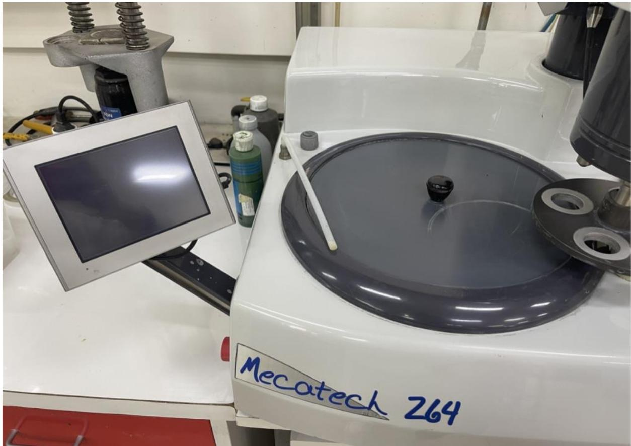
**Figura 22. Máquina de pulido automático para muestras.**
