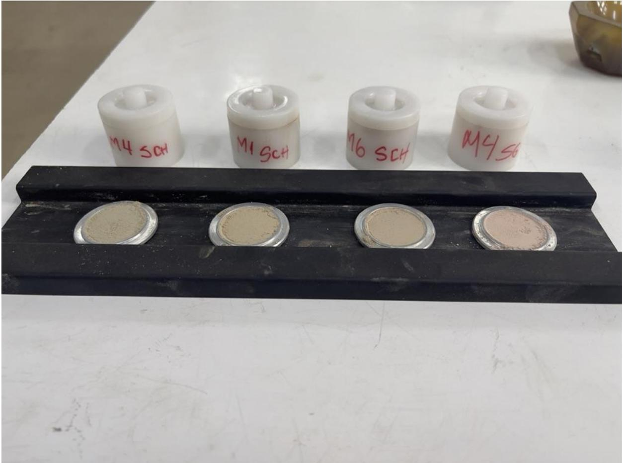
**Figura 21. Recipientes de muestras para análisis XRF (superior) y XRD (inferior).**
