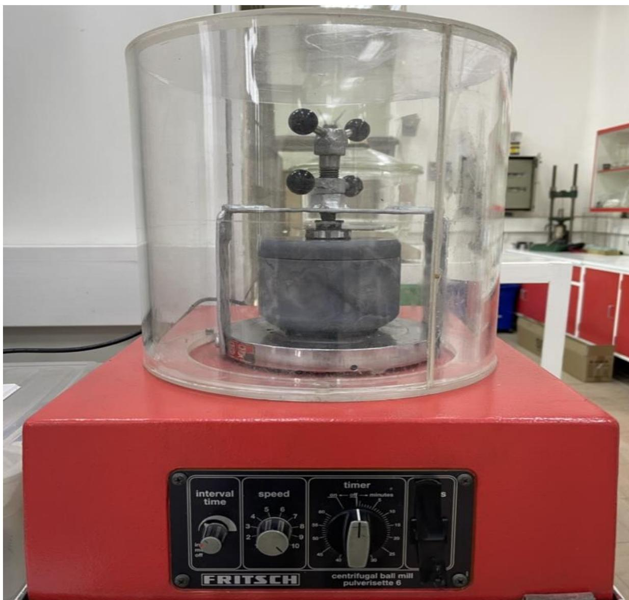
Figura 20. Molino centrífugo pulverizador de bolas.
