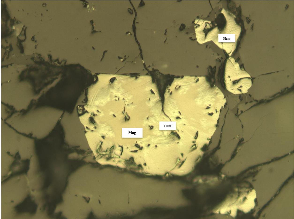
**Figura 39. Magnetita y Hematita interactuando en mineral.**
