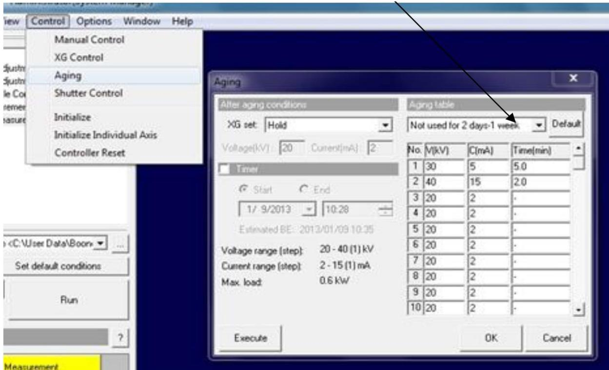
**Figura 27. Selección y verificación de las condiciones normales de operación del difractor. (Chinnathambi, 2013).**
