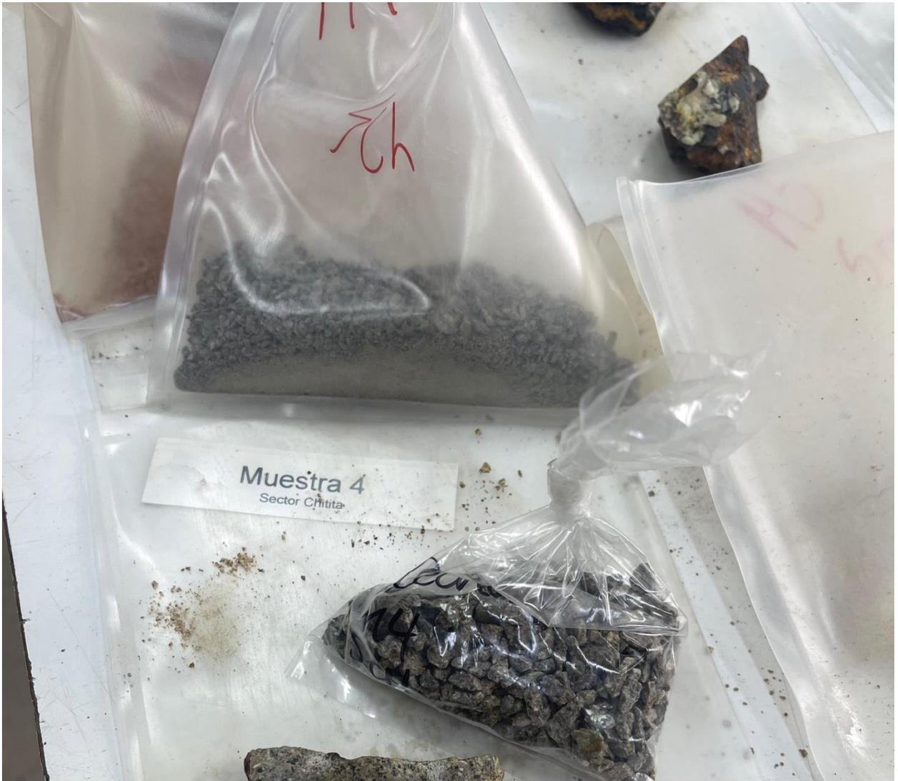
**Figura 49. Muestra y contramuestra tras el proceso de chancado.**
