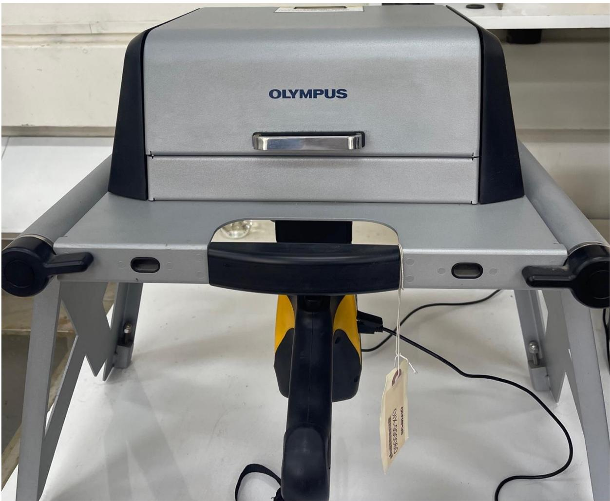
**Figura 23. Espectrómetro de rayos X con pistola instalada en su base.**
