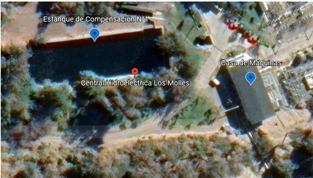
Figura 12: Estanque de Compensación ubicado junto a Casa de Máquinas. Volumen de 1000 [m<sup>3</sup>].
