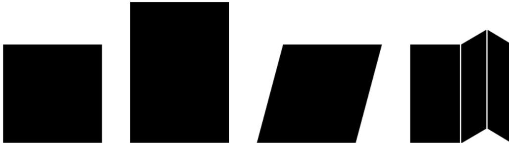
Figura 4.3: Tela en reposo, deformación de estiramiento, deformación de cizallamiento y deformación de plegado respectivamente.
