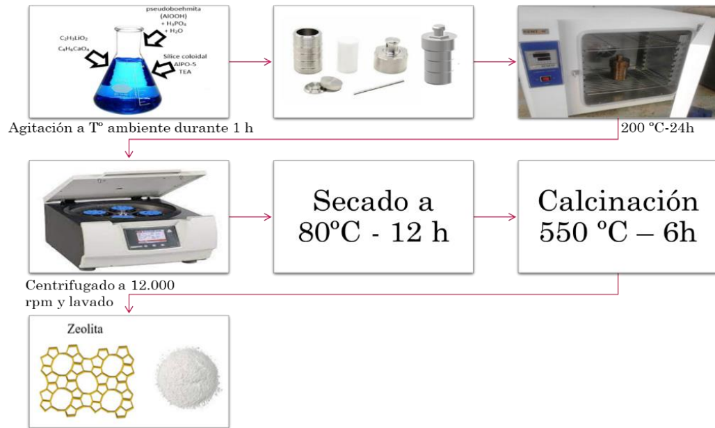
Figura 9. Esquema de la secuencia de síntesis de ambas zeolitas estudiadas, SAPO-5 y SAPO-34.
