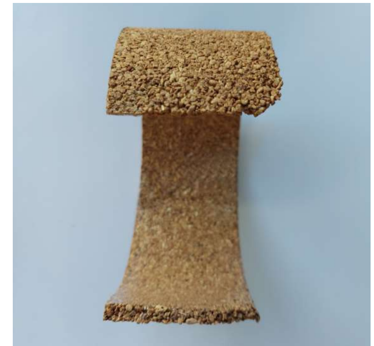
Curva mediante hidroformado. Elaboración propia.
