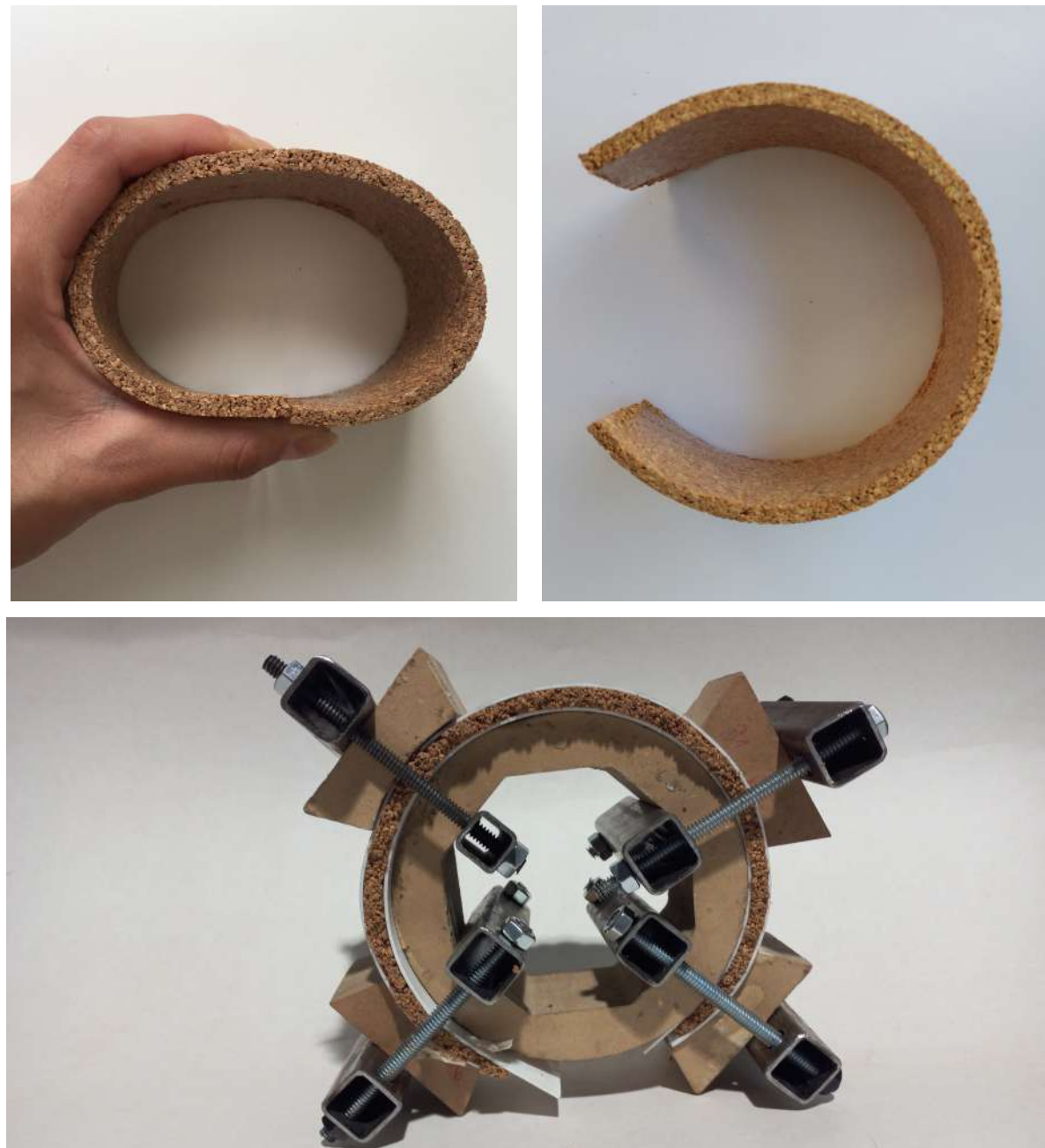
Curva mediante molde tipo c Elaboración propia.
