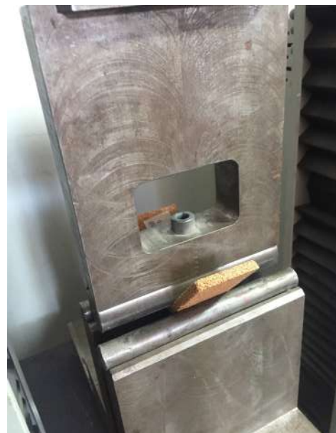
Ensayo Flexión. Elaboración propia.
