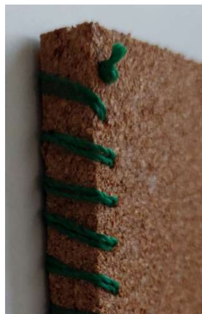
Prueba de trabajabilidad, corte y costura manual. Elaboración propia.
