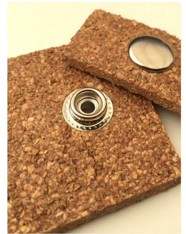
Prueba de trabajabilidad, perforado y ojales. Elaboración propia.
