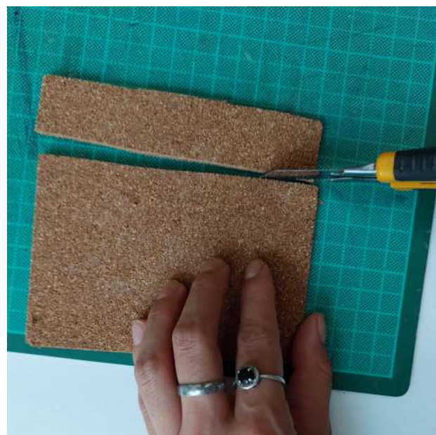
Prueba de trabajabilidad, corte y costura manual. Elaboración propia.
