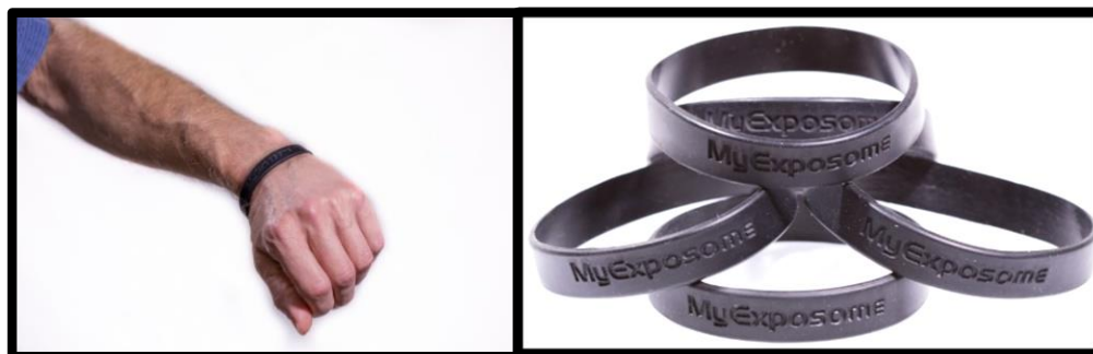
Figura 4 Pulsera de Silicona (WB) instalada para monitoreo personal de la exposición de compuestos orgánicos. Extraído de MyExposome, Inc.
