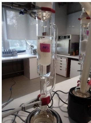
Figura 7. Proceso de extracción Soxhlet. Se observa la esponja o disco PUF cubierto completamente con solvente.
