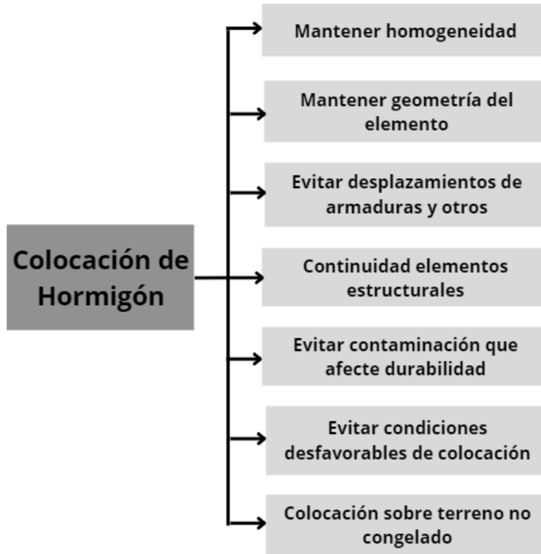
Figura 10: Condiciones a cumplir durante la colocación del hormigón. Fuente: elaboración propia a partir de (NCh 170: 2016: Hormigón - Requisitos Generales, 2016).
