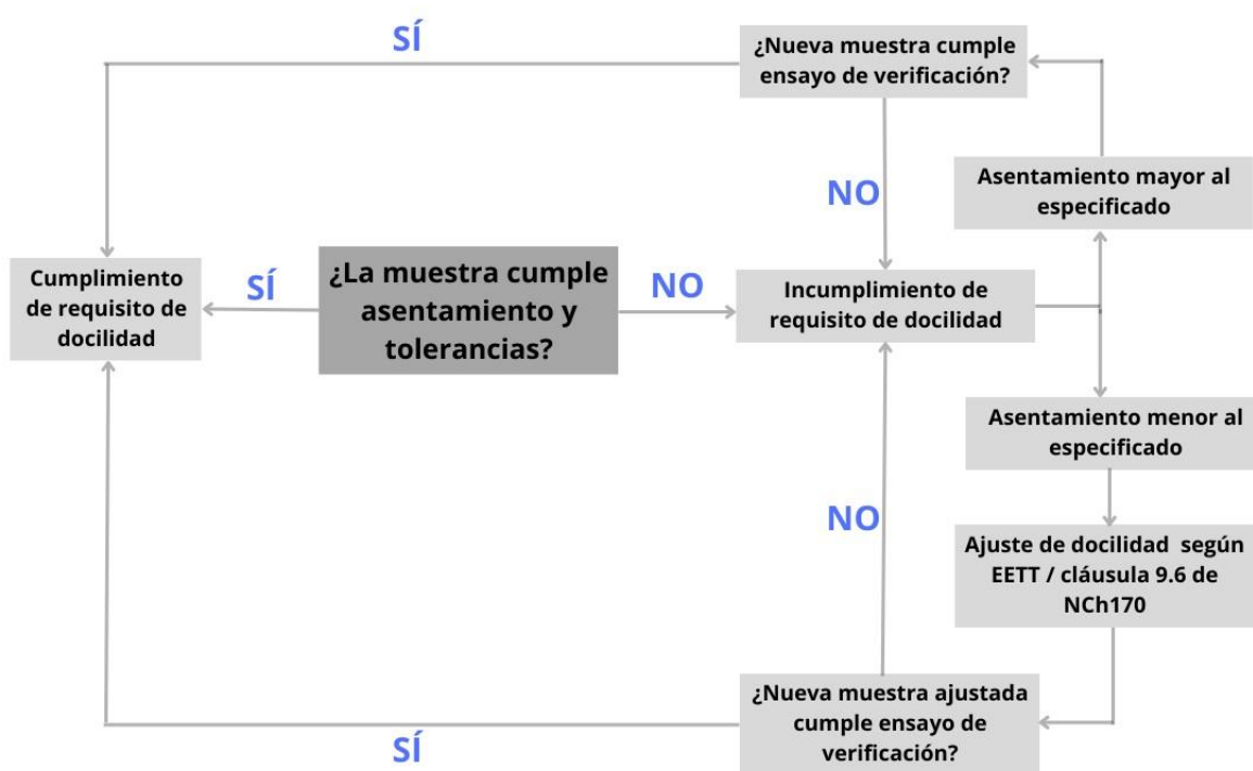
Figura 5: Diagrama de cumplimiento de requisito de docilidad. Fuente: elaboración propia a partir de (ACI301-16: Especificaciones para Concreto Estructural, 2016) y (NCh 170: 2016: Hormigón - Requisitos Generales, 2016).
