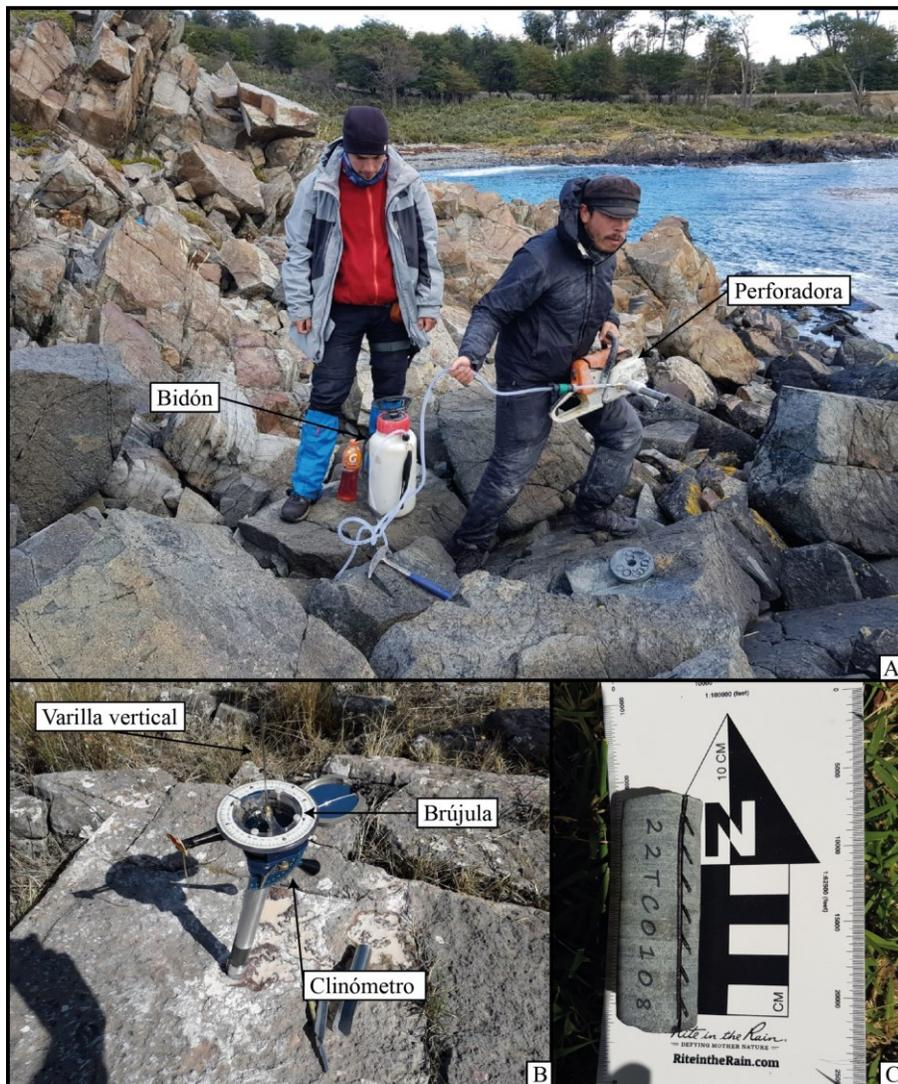
Figura 15. Muestreo paleomagnético. A) Equipo de perforación; B) Orientador; C) Testigo de paleomagnetismo obtenido en terreno.
