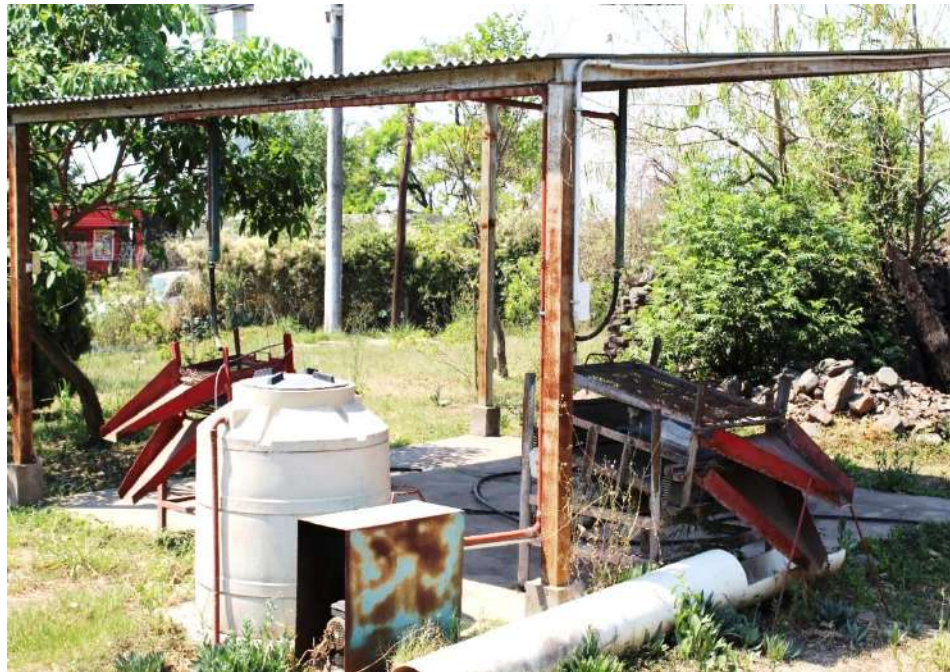
Figura 69 Sistema de zarandeo o harneo de los sedimentos extraídos desde la excavación del pozo.
