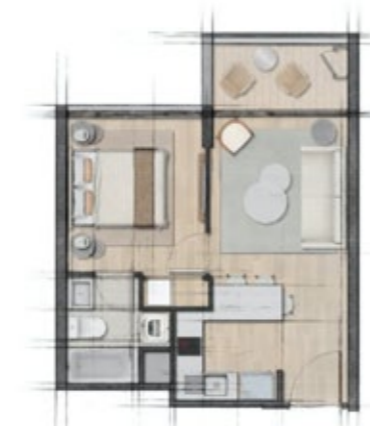
Figura 46. Edificio Touch, ubicado en Av. Vicuña Mackenna Oriente 6617, La Florida. Modelo 1D-1B (35,91 m 2 totales, espacio útil de 31,56 m 2 y terraza de 4,65 m 2 ).
