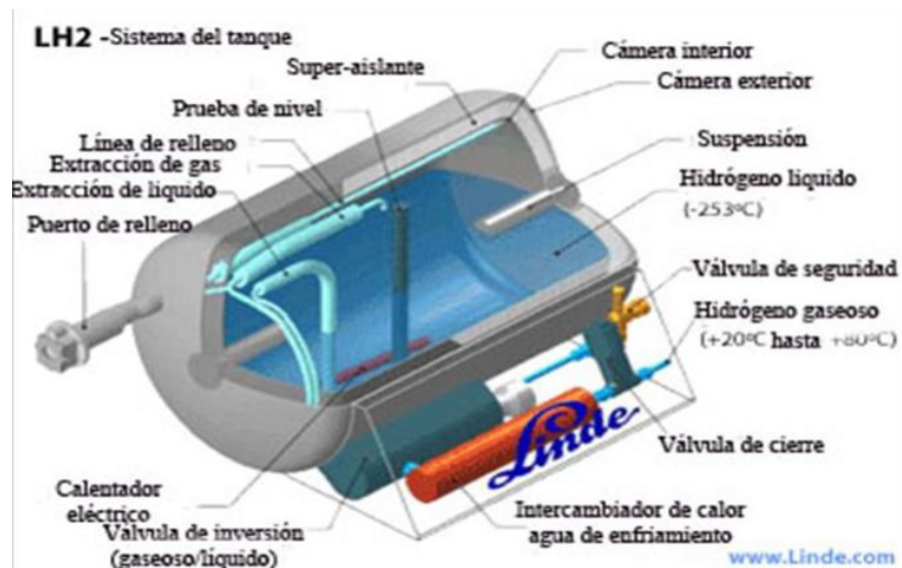
Figura 2.3.8: Representación esquemática de un vaso criogénico, diseño y componentes [17].
