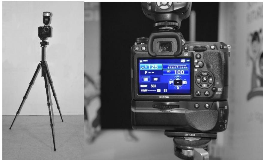
Figura 8. A. cámara Réflex digital modelo K-3, Pentax® montada sobre trípode modelo GT1544T, Gitzo®. B. Parámetros fotográficos utilizados (Fuente: Alvial, 2019)
