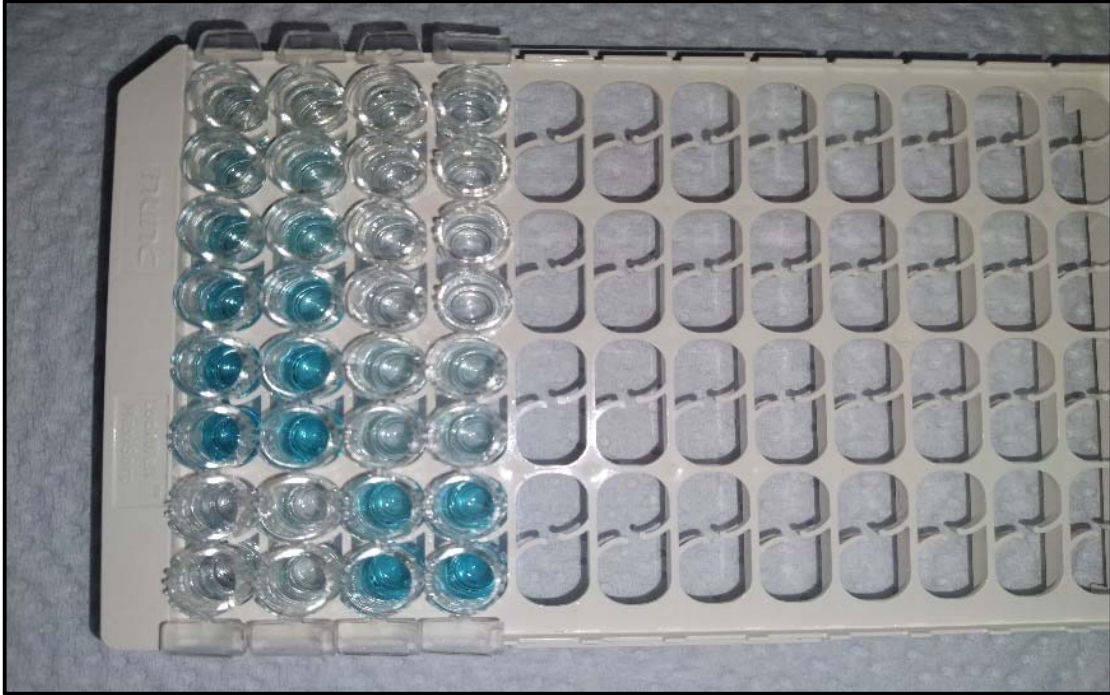
Figura N° 3: Placa ELISA conteniendo pocillos de ensayo en muestra de clotiazepam comprimidos trirranurados. Etapa posterior a la adición e incubación con el sustrato y cromógeno. Los pocillos coloreados en azul indican presencia de gliadina en la muestra.
