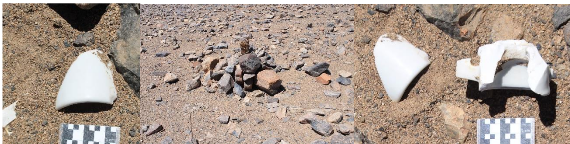
Figura 32: Restos de telégrafo con tecnología de porcelana. Izq y der: detalle de aislador de porcelana que sostiene el cableado. Al centro: poste de madera del telégrafo. Fuente: FONDECYT 1190023
