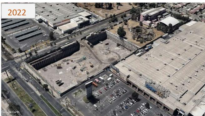
Imagen 20: Vistas aéreas de excavación abandonada junto a MH en Puente Alto, registrado en tres años diferentes por Google Earth.
