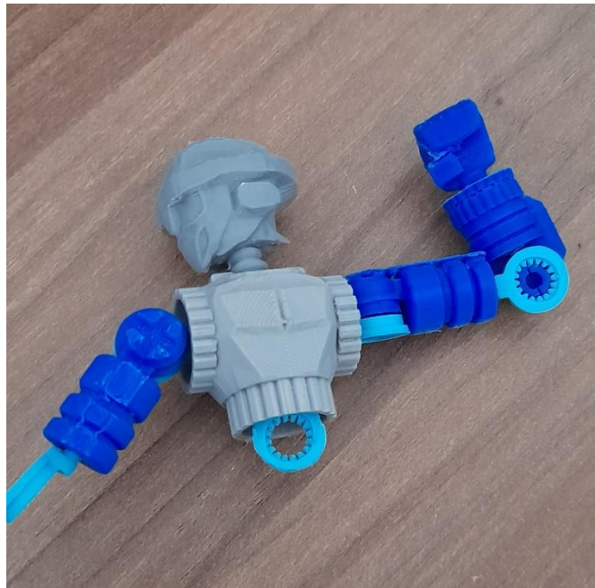
Fig 7.1 Esta será la pieza de ejemplo que contiene todas las articulaciones usadas. Elaboración propia.
