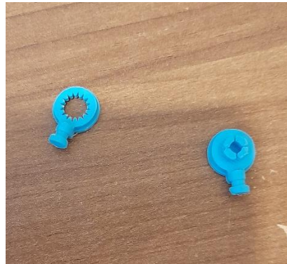
Fig 6.22 Articulación completa y separada impresa en filamento ABS. Elaboración propia.
