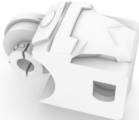
Fig 6.18 Pelvis modificada con unión tipo macho de la articulación y carcasas. Modelamiento Rhinoceros 3D Elaboración propia.
