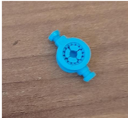
Fig 6.22 Articulación completa y separada impresa en filamento ABS. Elaboración propia.
