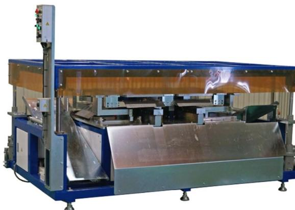
Figura 6.7: Separador semi automático del marco y de la caja de conexión [28].
