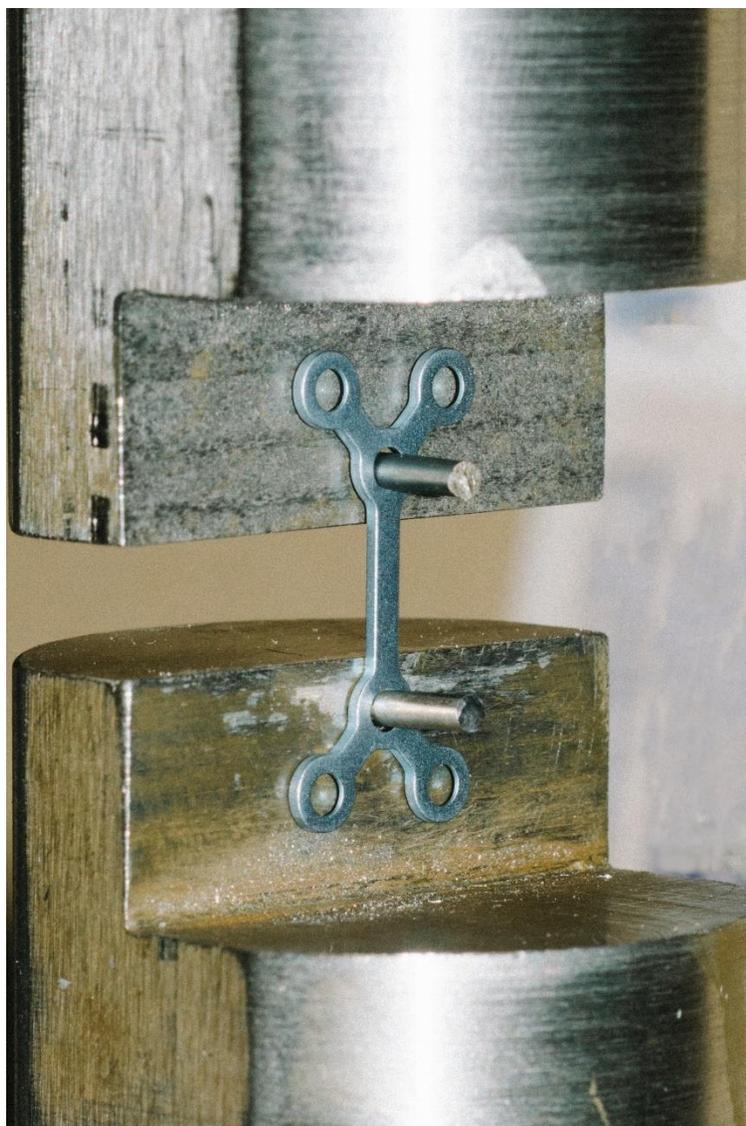
**FIGURA 7. Miniplaca posicionada para la prueba de tracción.** se presenta posición de pasadores y miniplacas en donde el sentido de las fuerzas aplicadas es opuesto entre sí.
