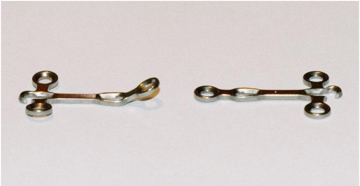
**Figura 14. Comparación de deformación del bisel:** a la izquierda miniplaca con bisel libre durante la tracción, a la derecha miniplaca con el bisel fijo
