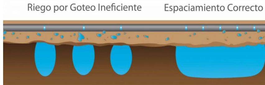
Figura 6. Espaciamiento correcto de emisores para lograr un gran bulbo por planta (Fuente: Rivulis Irrigation Ltda., 2019).
