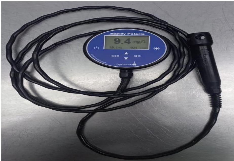
**Figura 10.** Dispositivo de Oxiguard de marca Handy Polaris.
