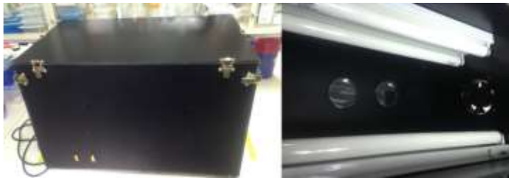
Figura 2. Cámara de exposición a luz UVB. Esta posee 4 tubos Phillips TL20W/12, con un peak de longitud de onda de 320 nm y 20 W de potencia, agrupados en dos niveles que permiten regular la intensidad de la radiación. Es desmontable, lo que permite transportarla y utilizarla en terreno.
