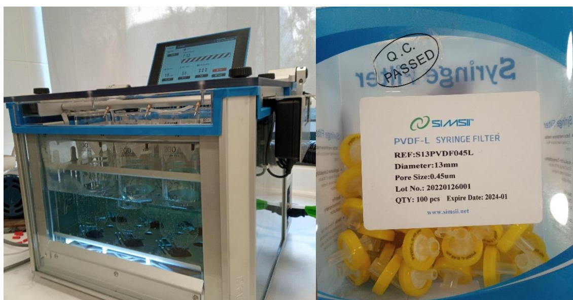
Figura 6. Concentración de extractos en TurboVap (izquierda) y filtros de jeringa utilizados para limpieza de las muestras (derecha).
