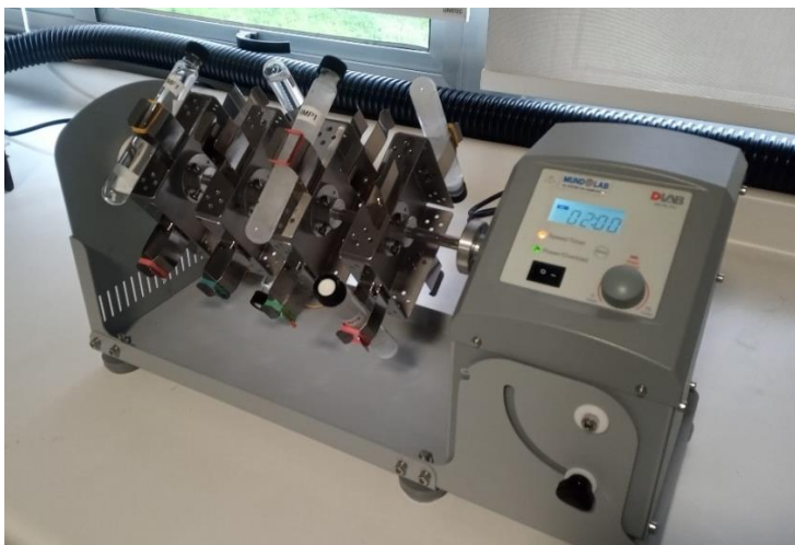
Figura 5. Extracciones desde ambos sustratos mediante agitación mecánica.
