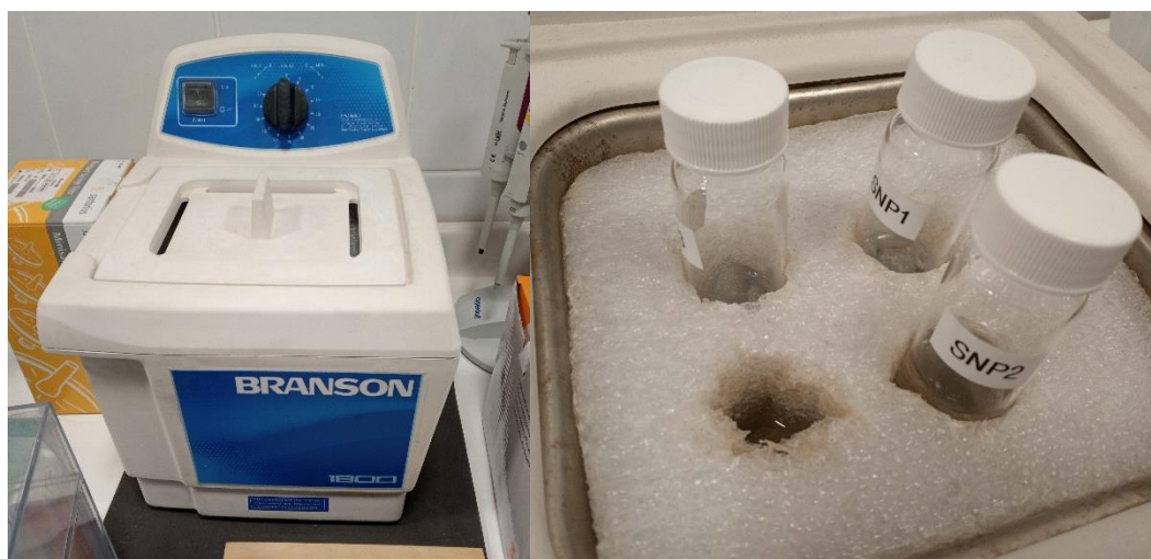
Figura 4. Extracción desde PUF mediante sonicación.
