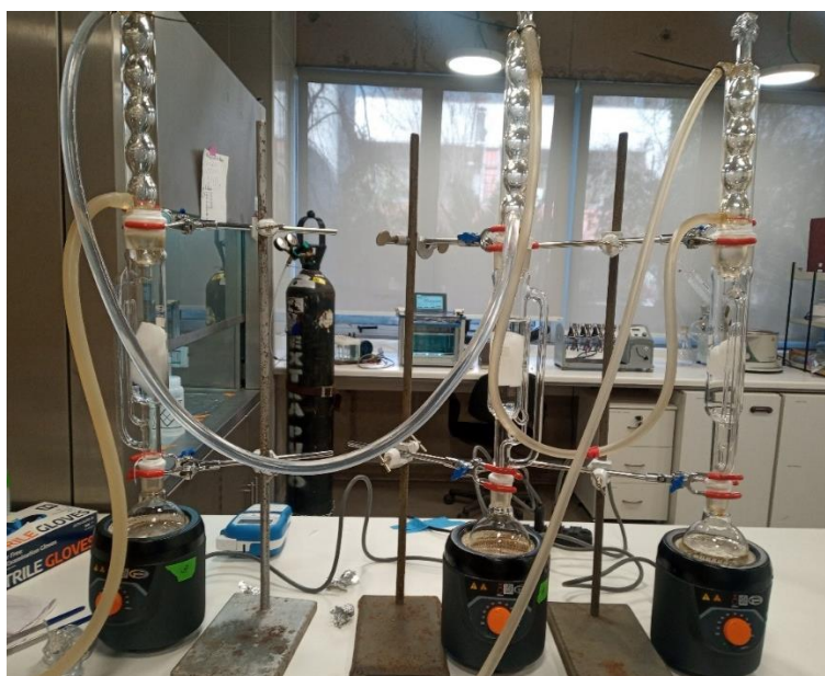
Figura 2. Montaje de los equipos soxhlet en serie para las extracciones desde PUF.
