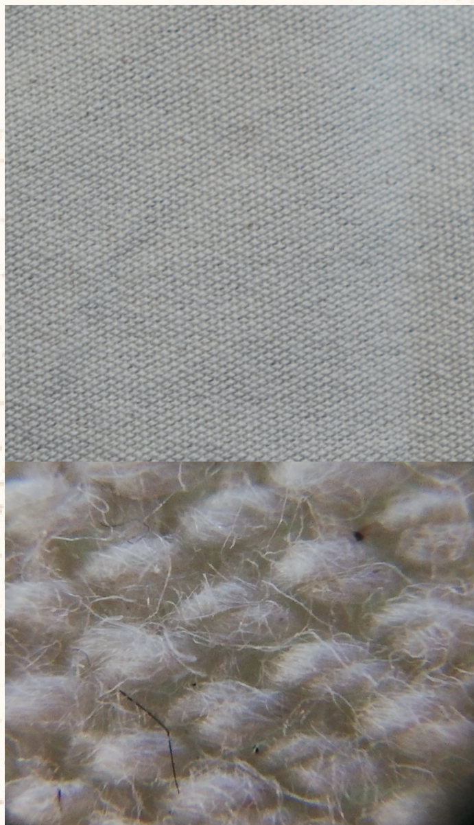
Figura 128: Fotografías de la estructura de la loneta
