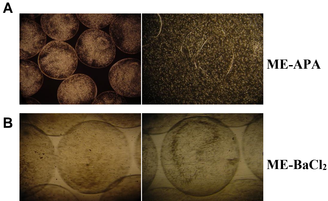
Fig. 19. Visualización Microscópica (10x) de la disolución de Microesferas APA (A). Disolución con EDTA 50mM, Carbonato de Calcio pH 8.8, Citrato de Sodio 50 mM. Las ME-BaCl 2 no fueron alteradas tras la incubación por > 48 hrs. (B).
