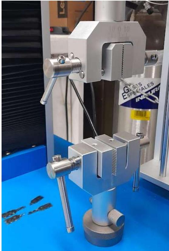
**Figura 24.** Mordaza empleada para la ejecución de los ensayos mecánicos.
