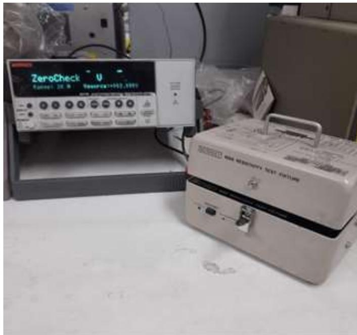
**Figura 28.** Analizador de alta resistividad Keithley 6517B.
