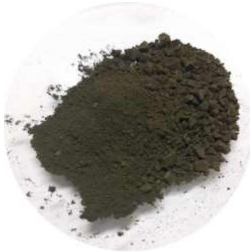
**Figura 8.** Apariencia del GO sintetizado mediante el método Brodie.
