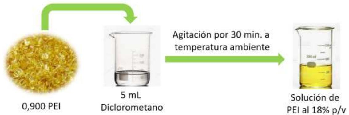
**Figura 6.** Esquema representativo de la preparación de la solución al 18% p/v de PEI.
