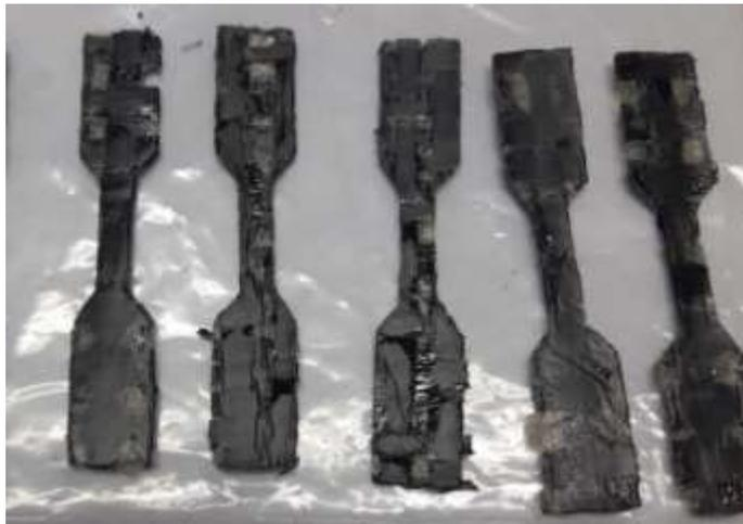
**Figura 104.** Forma de las probetas usadas para los ensayos mecánicos de esfuerzo-deformación de los CLRFC.
