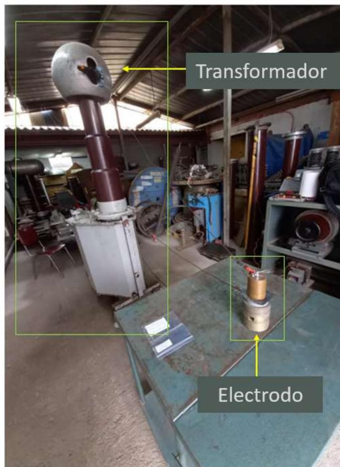
**Figura 27.** Transformador de 150 [kV] empleado para las medidas de rigidez dieléctrica.
