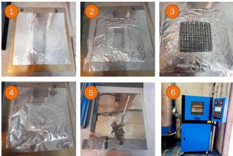
**Figura 26.** Procedimiento ejecutado para la obtención de los CLRFC: preparación de lase metálica del molde de prensado (1), preparación del molde de prensado (2), incorporación de los tejidos nanocompuestos de forma alternada en el molde de prensado (3), sellado del molde de prensado (4-5) e introducción de la muestra a la prensa hidráulica para ser moldeada a 270° C (6).
