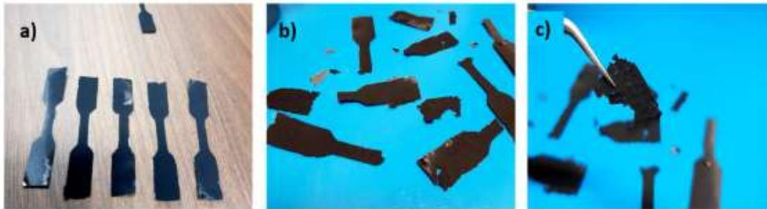
**Figura 93.** Muestras de PEI/rGO para ensayos mecánicos: probetas cortadas (a), probetas analizadas por ensayos mecánicos (b), apariencia quebradiza de las probetas (c).
