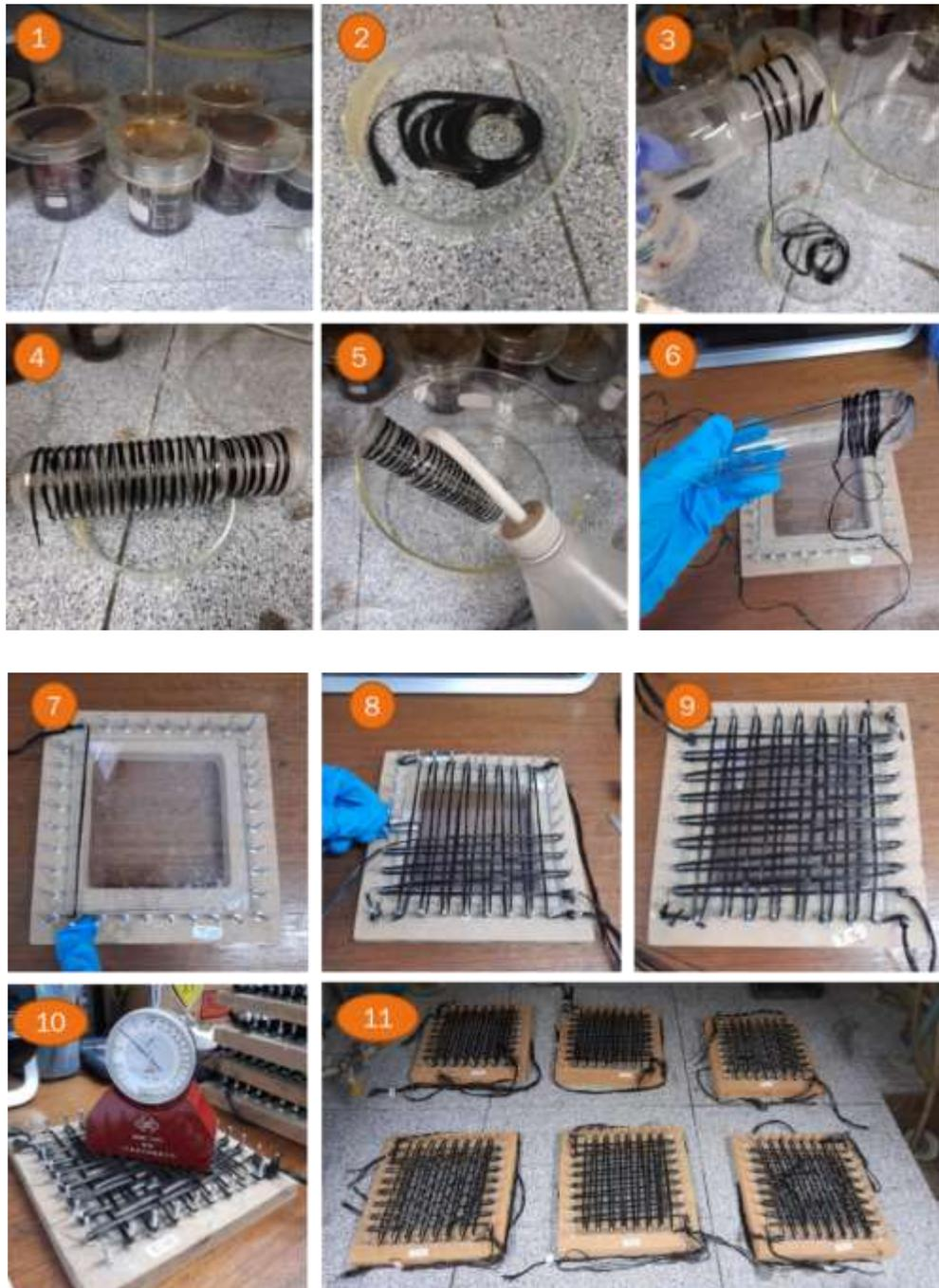
**Figura 25.** Procedimiento empleado para la obtención de los tejidos de FC oxidada y sin oxidar: oxidación de la FC (1), lavado de la FC oxidada con  $H_2O_2$  (2), secado de la FC (3-5), hilado y tejido de la FC (6-9), medida de la tensión de los tejidos de FC obtenidos (10) y tejidos de FC preparados (11).
