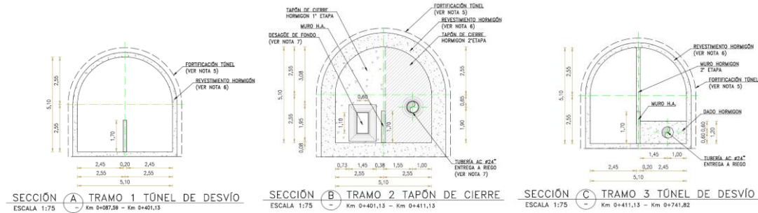
Ilustración 3.15: Plano Secciones del Túnel de Desvío.
