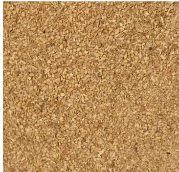
figura 76. Mesh 35 ( $\geq 0,5$  mm) 7,4%
