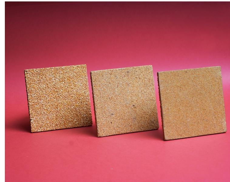
*figura 90. Probetas fabricadas con una granulometría superficial de 18, 35 y 50 mesh respectivamente. Elaboración propia.*
