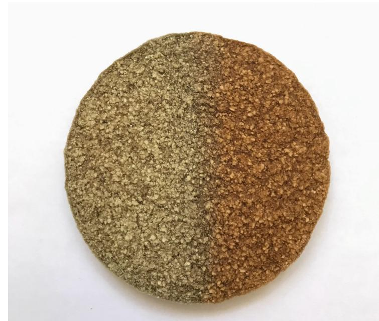
figuras 25 y 26. Resultados de impresión con fuentes lumínicas naturales y artificiales sobre biomaterial de carozo de cereza y agar. Elaboración propia (2021)
