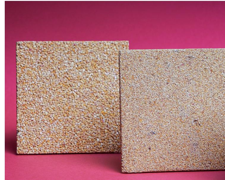
*figura 89. Probetas fabricadas con una granulometría superficial de 18, 35 y 50 mesh respectivamente. Elaboración propia.*
