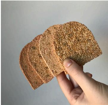
*figura 84 y 85. Aparición de hongos en probetas fabricadas con aglomerante Smartbricks. Elaboración propia.*
