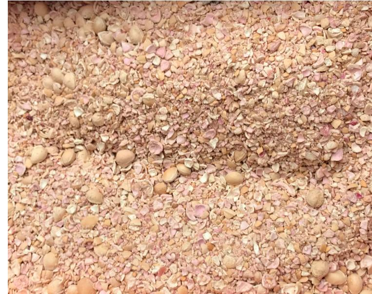
figura 46 y 47. Diferentes granulometrías de carozo de cereza posteriores a la molienda.
