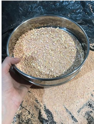
figura 48 y 49. Proceso de análisis granulométrico en diferentes categorías. Elaboración propia.
