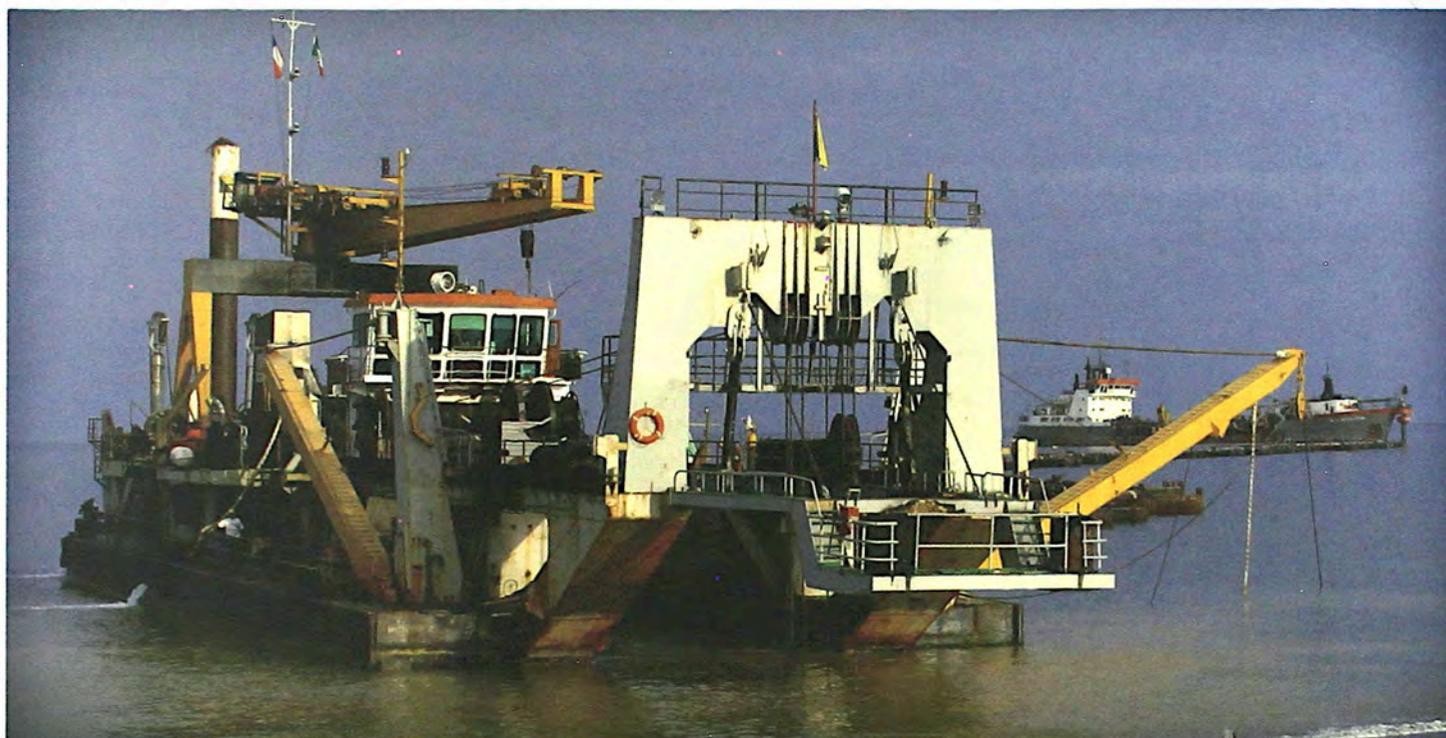
Para efectuar estos trabajos fue necesario movilizar desde el extranjero a Mejillones dos grandes equipos de dragado. Para el dragado de la roca diatomácea, una draga de corte y succión de gran capacidad con una potencia total de 8300 HP. Para el dragado de la arena y el transporte del material extraído por la draga de corte, una draga de succión en marcha, autopropulsada con una potencia instalada total de 12.000 HP y una capacidad de cantara (bodega) de 5.000 m<sup>3</sup>.
