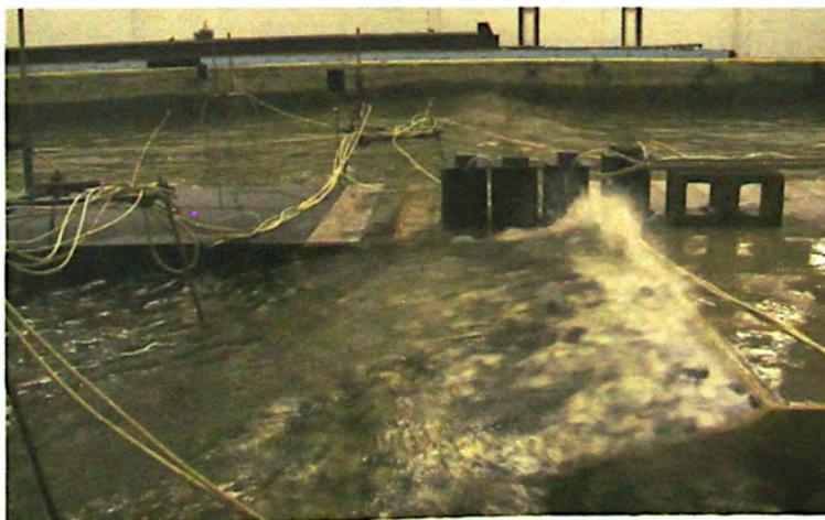
Para estos efectos se construyó un modelo a escala del proyecto, en una pileta de 14 m por 60 m, en el mismo laboratorio, para medir esfuerzos provocados por el oleaje máximo o de diseño sobre la estructura de los muelles. Se verificó el comportamiento de las protecciones de taludes en base a enrocados y elementos prefabricados denominados CORE-LOC.
