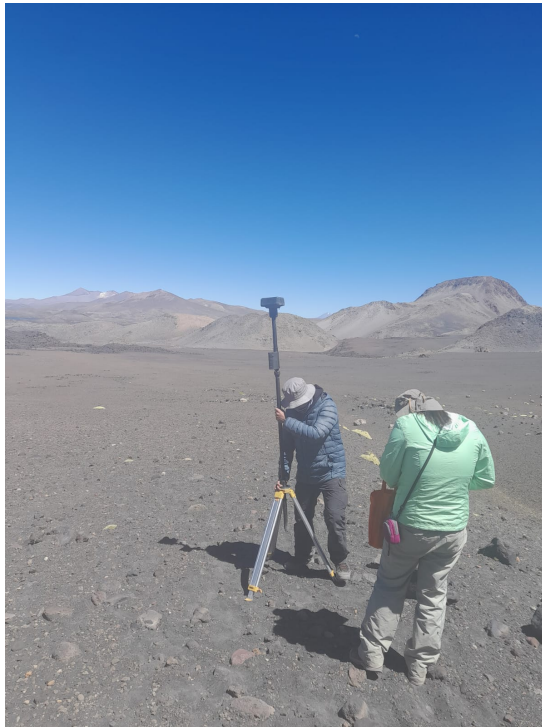
Figura 4.2: Instalación del RTK.
