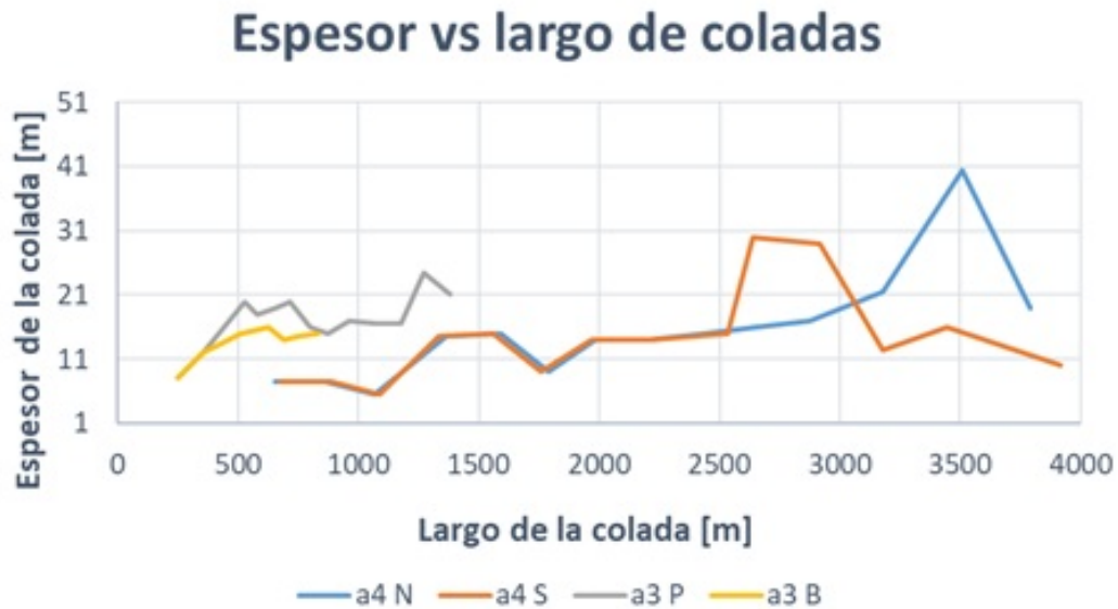
Figura 5.22: Gráfico de espesor vs. largo de las coladas. La línea azul corresponde al flujo Ajata superior, específicamente a la zona norte del flujo, la línea naranja corresponde a la zona sur del flujo Ajata superior, mientras que la línea gris corresponde al flujo principal del Ajata inferior y la línea amarillo representa al lóbulo del Ajata inferior.
