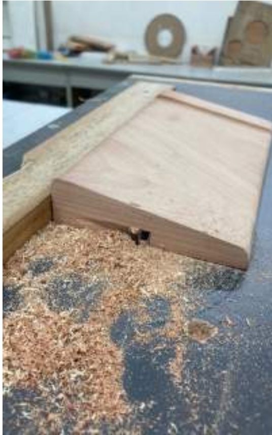
Figura 87. Fresado cola de milano para riel. Autoría propia
