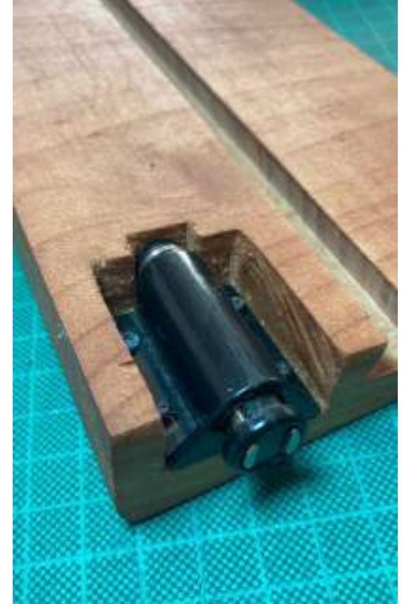
Figura 89. Tallado para ubicación de pieza Push to open. Autoría propia
