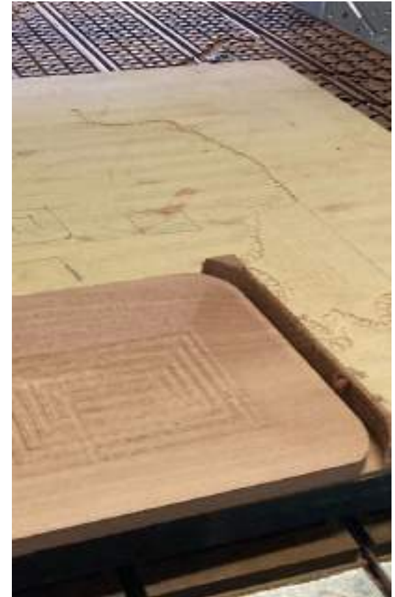
Figura 80. Proceso de mecanización Router CNC. Autoría propia
