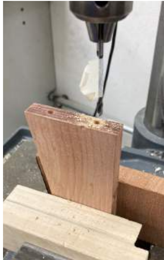
Figura 82. Perforaciones para tarugos. Autoría propia
